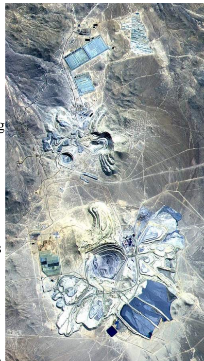
Abb. 7: Rohstoffabbau im Tagebau führt zur Zerstörung von Landschaften / Ökosystemen und zur ausgedehnten Absenkung des Grundwassers mit weitreichenden Schäden für die Umwelt. Hier der Abbau von Kupfer im Escondida-Kupferbergwerk in Chile (NASA image of Escondida Mine in Chile, taken by en:ASTER on April 23, 2000 )
