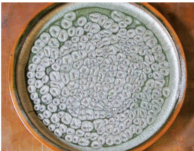
Abb. 8 Bénard-Konvektion. [Abdruck mit freundlicher Genehmigung der Fakultät für Physik der Universität Freiburg]
